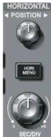
Figura 2-11 Interface do Sistema Horizontal
