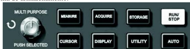
Figura 2-20 Teclas de Função para o Sistema de Armazenamento
