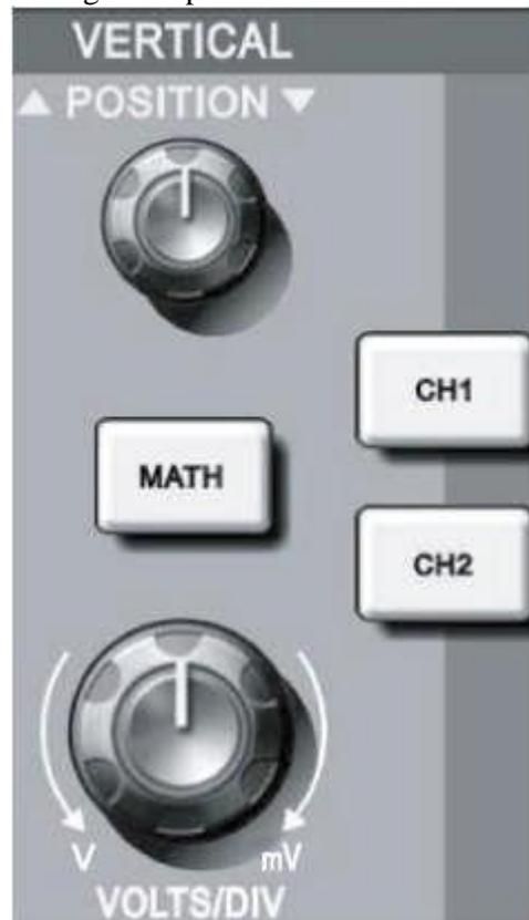
Figura 1-9 Área de Controle Vertical do Painel Frontal
