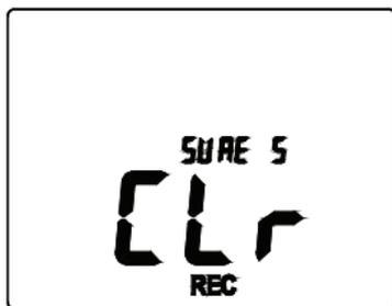
Com o equipamento desligado, pressione a tecla **REC** e a tecla **Ⓢ** por pelo menos 5 segundos, aparecerá no display o símbolo “CLR” indicando que os dados foram apagados.
