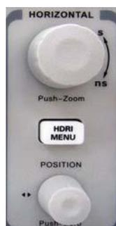
Figura 2-12 Interface do Sistema Horizontal
