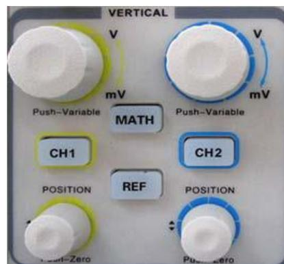
Figura 1-9 Área de Controle Vertical do Painel Frontal
