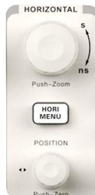
Figura 1-10 Área de Controle Horizontal no Painel Frontal
