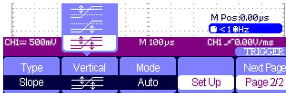
Figura 2-47 Menu de Trigger da função Slope 2
