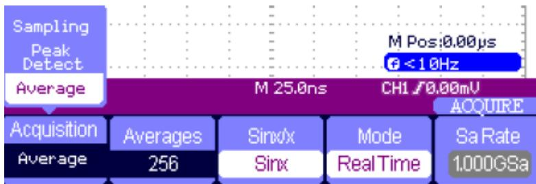
Figura 2-8 Menu das funções do sistema do modo de aquisição
