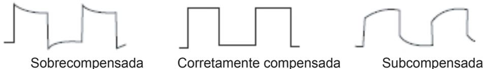
Figura 5. Calibração da compensação da ponta de prova
